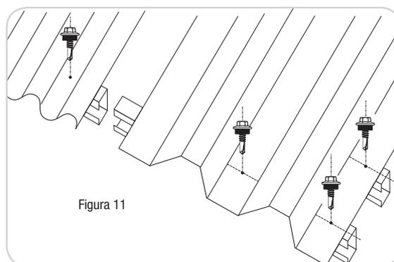
Recomenda-se que o furo seja feito numa distância de, no mínimo, 25 mm da borda da telha, aplicando-se quatro fixadores por telhas e por apoio.
