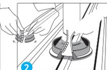
2 Com o fecho virado para baixo, envolva a parte superior da flange e acople os dentes de metal nas cavidades opostas, começando na parte superior
