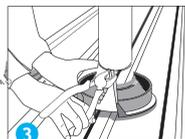
3 Para auxiliar a colocação do fecho na cavidade, coloque a mão atrás da costura. Aperte o fecho com um alicate, trabalhando de cima para baixo. Não dobre em excesso
