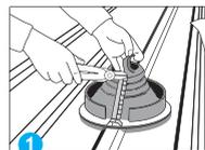
1 Recorte a flange para adaptá-la ao tamanho do tubo utilizando uma tesoura ou estilete
