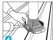
4 Aplique selante de silicone neutro ou poliuretano na base da flange, e molde à forma do telhado
